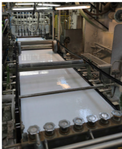
Tamis en plastique à l'entrée de la machine à forme plate.
