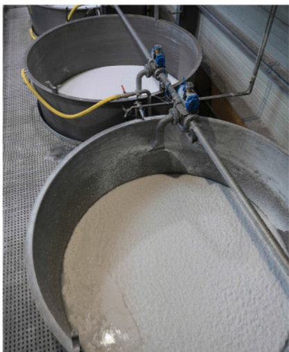
La pâte à papier est broyée, malaxée et mélangée à de nombreux ingrédients appelés “charges”.
