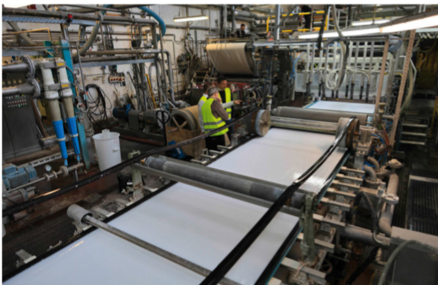
Sur la machine à forme plate , les fibres se répartissent uniformément dans le sens de la marche du tamis.
