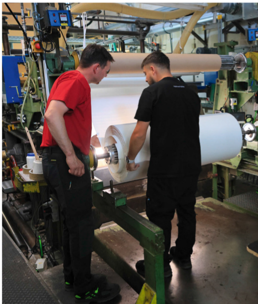
Le papier est réceptionné à l'extrémité des deux machines sous forme de bobines ou de feuilles.
