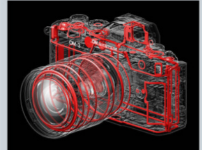
OM System a soigné la résistance de son boîtier, qui, outre une fabrication entièrement en métal pour un poids contenu de 500 g, dispose de multiples joints d'étanchéité lui valant une certification IP53.
