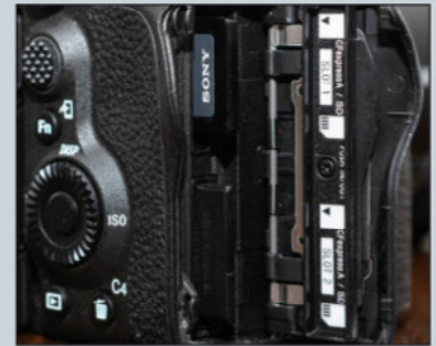
Le double lecteur de cartes mémoires peut indifféremment recevoir dans chaque logement une carte SD au standard UHS-II ou une carte CFexpress Type A.
